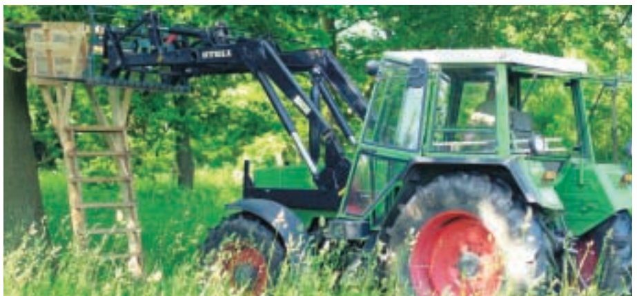
Nachdem die Baumleiter mit dem Frontlader oder auch per Hand in die richtige Position gebracht wurde, zurt man sie mit Spanngurten am Baum fest
