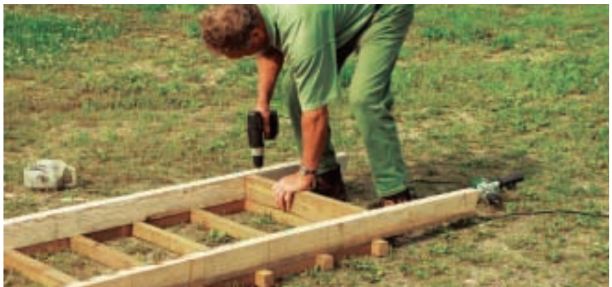
Die Leiterholme werden auf eine lichte Weite von 70 Zentimetern gelegt. Die sieben Sprossen haben zueinander einen Abstand von 23 Zentimetern. Die oberste Sprosse dient zudem als Fußablage. Dazu werden zwischen die Holme zwei Latten fixiert (oben). Die schräg angebrachte Sitzauflage hat einen Winkel von 102 Grad (rechts). Mit einer Schablone (unten) lassen sich beide Hölzer gleichwinkelig anbringen
