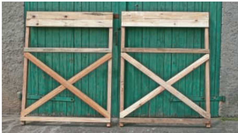
Vorder- und Rückseite, die baugleich sind, bilden den Ausgangspunkt des Schirms. Die Diagonalkreuze sind dabei sehr wichtig für die Stabilität des Sitzes
