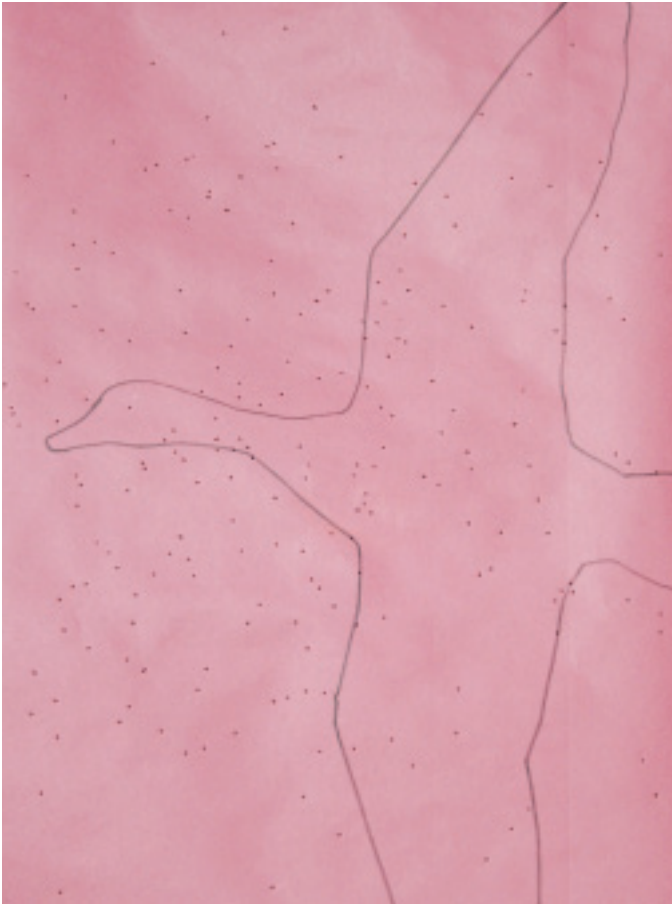
So muss ein Schussbild aussehen – erzielt wurde es mit der SK „Torhammer“ im Kaliber 12/70 (3 mm, 36 g) auf 30 Meter
