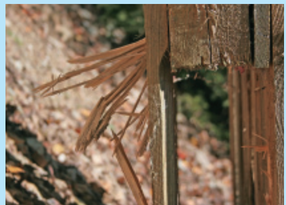
Bedenkliche Wirkung: Eine Europalette wurde noch auf 65 Meter von der „Schrotladung“ durchschlagen
