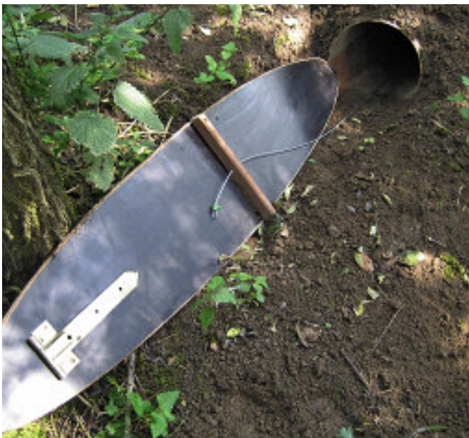
Wippe vor dem Einbau: Gut sind Achse, Feststellelement und Edelstahl Draht, der zum Verschlussstück führt, zu erkennen.
