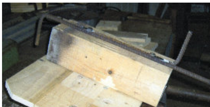
Fester Stand: Der Anker für die Falle wird aus robustem Torstahl angefertigt (oben) und am Kantholz der Fallenwand (links) verschraubt.
