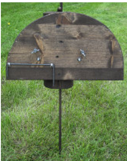
Fast alles dran: Der Halbmond mit Anker, Sicherheitsauslöser (Teil 2), Schrauben und Flügelmuttern für das Eisen
