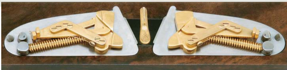
Vergoldet: Die von Hand herausnehmbaren Seitenschlösser zeugen von vollendeter Büchsenmacherkunst. Ersatzschlösser für den Fall der Fälle gehörten zum Lieferumfang
