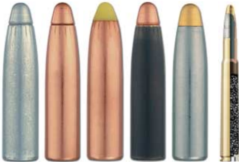
Entwicklungsstadien: Neben verschiedenen Materialien für die Geschosspitze probierte RWS auch unterschiedliche Beschichtungen aus. Die Metallspitze und eine Vernickelung des Tombakmantels flossen schließlich in die Serienpatrone (r.) ein
