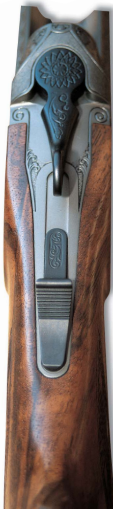
Der Spannschieber der Schlosse liegt griffgünstig auf dem Kolbenhals, lässt sich aber etwas schwerer vorschieben als beispielsweise bei der B 95 mit einem Schloss
