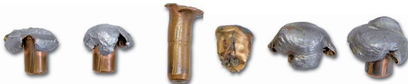
Nach dem Schuss (von links): zwei Trophy Bonded-Geschosse im Kaliber .30, geborgen aus starken Sauen, ein bleifreies Lapua „Naturalis“ im Kaliber .30 aus Kudu, A-Square Dead Tough im Kaliber .375 aus Büffel, zwei „Oryx“ im Kaliber .375 aus Gnu. Bis auf das Dead Tough ohne Bonded-Konstruktion mit etwa 60 Prozent kommen alle anderen Geschosse auf Restgewichte zwischen etwa 90 und 99 Prozent
