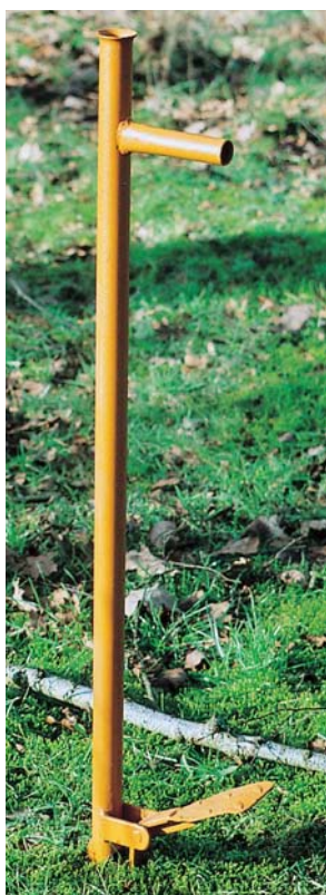
Der Saatstock „Eichelhäher“ (links) ist zum Legen von Eicheln in etwa sechs Zentimeter Tiefe gedacht. Zum Werben und Pflanzen von Jungbäumen wurde der Hohlspaten (Mitte) konzipiert. Der so genannte Göttinger Fahrradlenker (rechts) bietet deutliche ergonomische Vorteile für den Anwender
