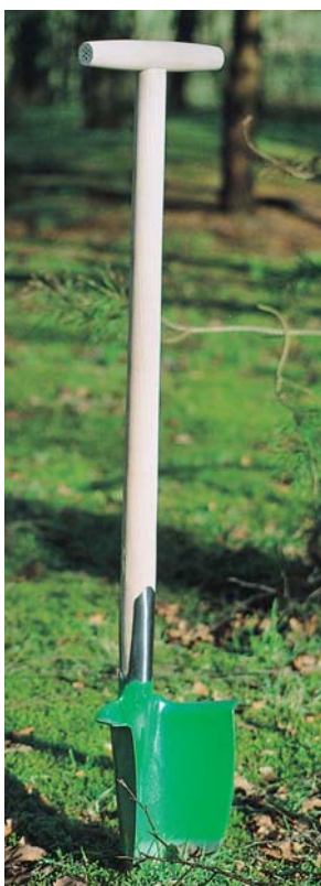
Der Saatstock „Eichelhäher“ (links) ist zum Legen von Eicheln in etwa sechs Zentimeter Tiefe gedacht. Zum Werben und Pflanzen von Jungbäumen wurde der Hohlspaten (Mitte) konzipiert. Der so genannte Göttinger Fahrradlenker (rechts) bietet deutliche ergonomische Vorteile für den Anwender
